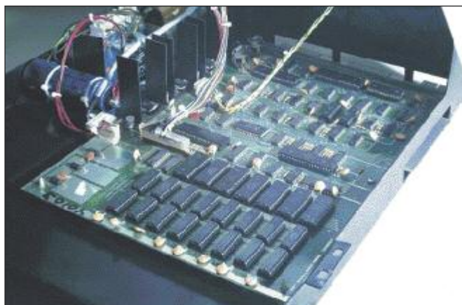
(A) An príomhchlár loighce sa mhicríríomhaire Commodore PET 2001, ón mbliain 1979.
